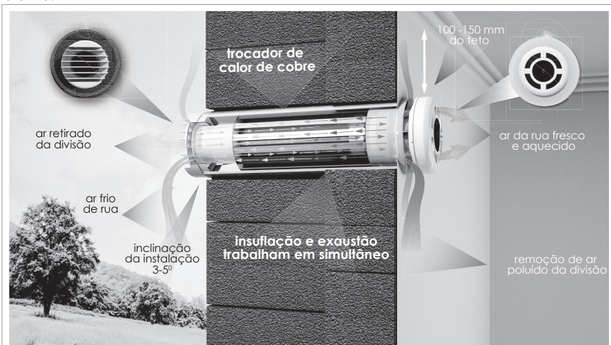
Fig.1 O princípio de trabalho de recuperador PRANA-150, PRANA-200C, PRANA-200G
