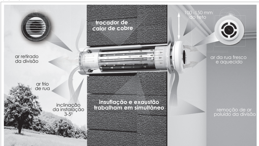
Fig.1 O princípio de trabalho de recuperador PRANA-150 ERP, PRANA-200C ERP, PRANA-200G ERP
