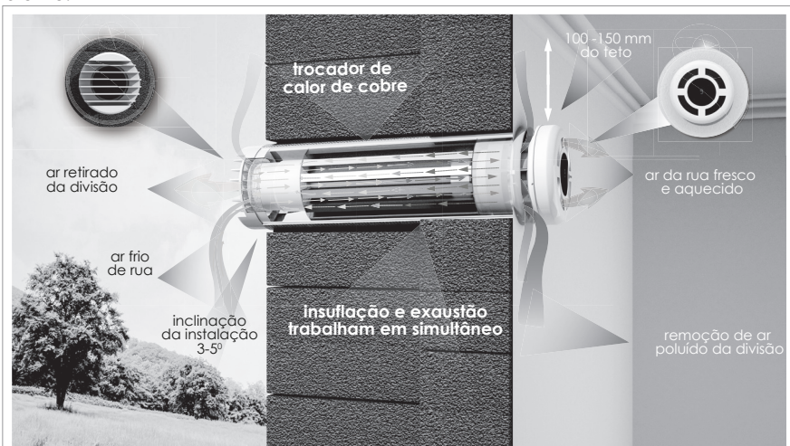
Fig.1 O princípio de trabalho de recuperador PRANA-150 ERP PRO, PRANA-200C ERP PRO, PRANA-200G ERP PRO
